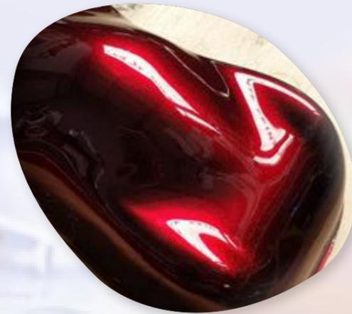
Il est normalement nécessaire de l'appliquer conjointement avec une 2e couche métallisée ou nacrée afin de faire rebondir la lumière. Une peinture Candy dans le modélisme RC peut-être parfois appliquée sans sous-couche, lorsque l'on veut teinter les zones des vitres ou des pare-brises.
